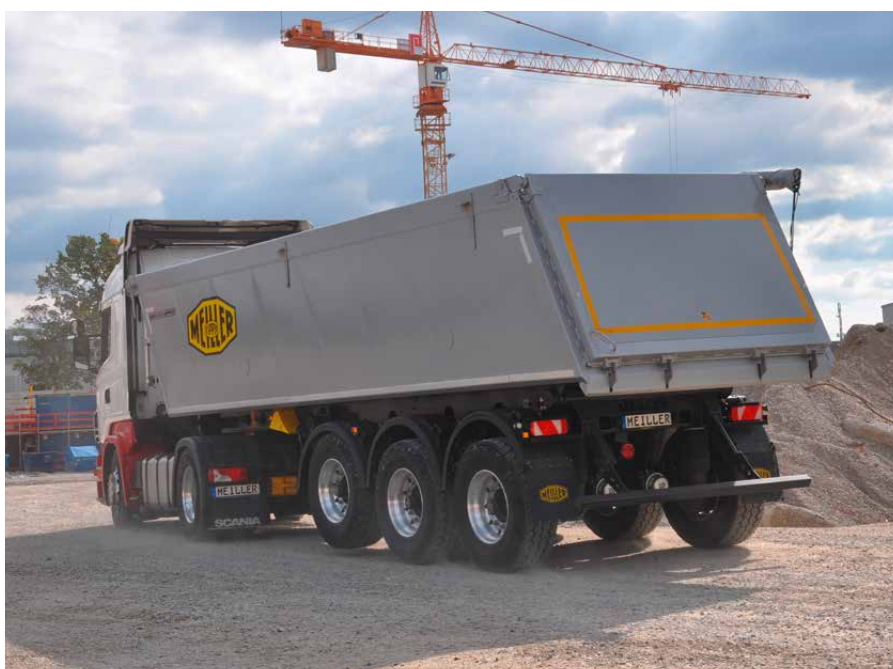
Der Kippsattel MHKA Kasten in Aluminium-Sandwichbauweise.
